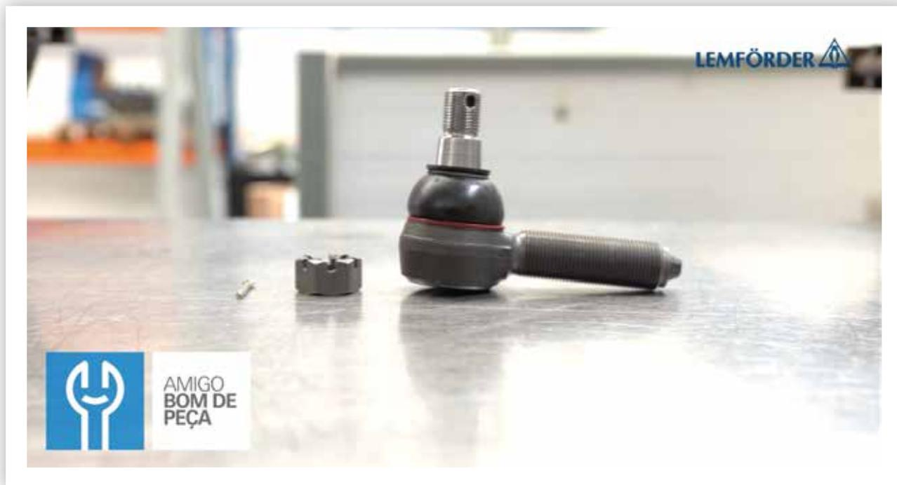
**ATENÇÃO:** Essa peça é fundamental para a segurança do veículo, afinal age diretamente no seu comportamento, garantindo a correta dirigibilidade e estabilidade do veículo. É possível perceber que, quando os terminais estão gastos, ficam com folga e provocam a trepidação da direção.
