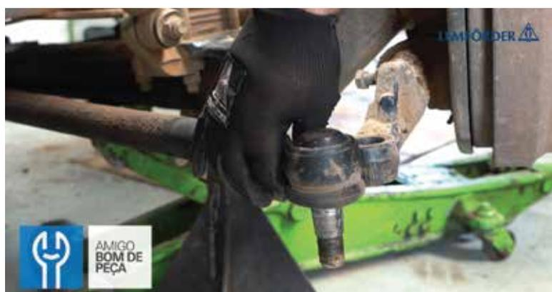
Agora, instale o extrator de terminal de direção e retire os terminais da barra de direção.
