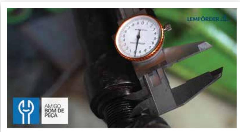
Instale o terminal de direção, para isso basta colocá-lo na mesma posição do anterior, observando a medição.
